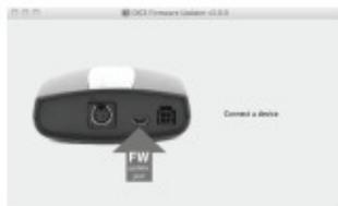
Connect module via mini USB
