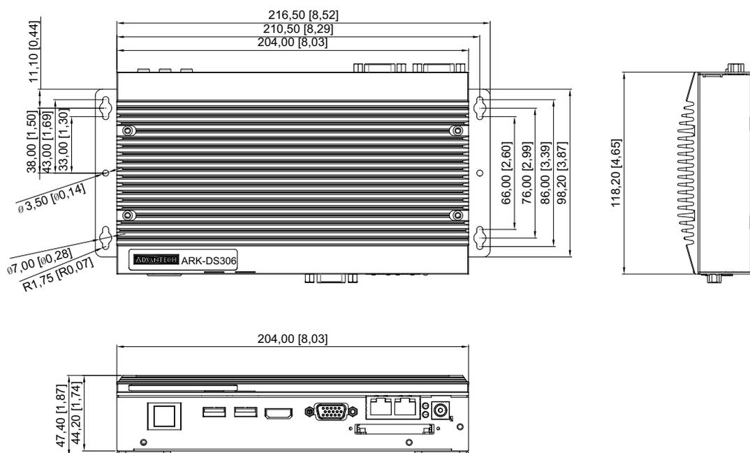
Figure 1.1 ARK-DS306 Mechanical Dimensions
