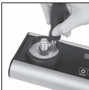
Figura 7. Limpieza de la celda.
