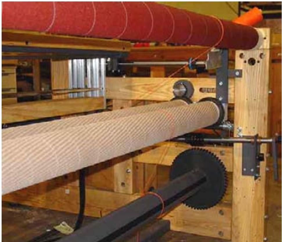
**PRESSURE ROLLERS MOUNTED ON THE LOOM WITH
