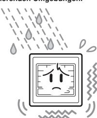
Bei Installation unter Bedingungen mit hoher Luftfeuchtigkeit, Spritzwasser oder starker Vibration können Störungen verursachen.
