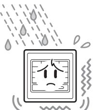
Si se instala en una zona en la que quede expuesto a mucha humedad, agua o vibraciones, podría producirse un funcionamiento incorrecto.
