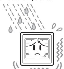
L'installation dans un endroit fort humide, sujet à des éclaboussures ou à d'importantes vibrations risque de provoquer des dysfonctionnements.
