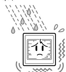
Установка в местах повышенной влажности, воздействия влаги или вибрации может привести к появлению неисправностей в работе прибора.
