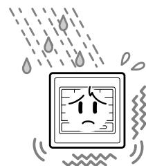
Porque se for exposto a um excesso de humidade, a salpicos de água ou a vibrações excessivas, irão surgir problemas.
