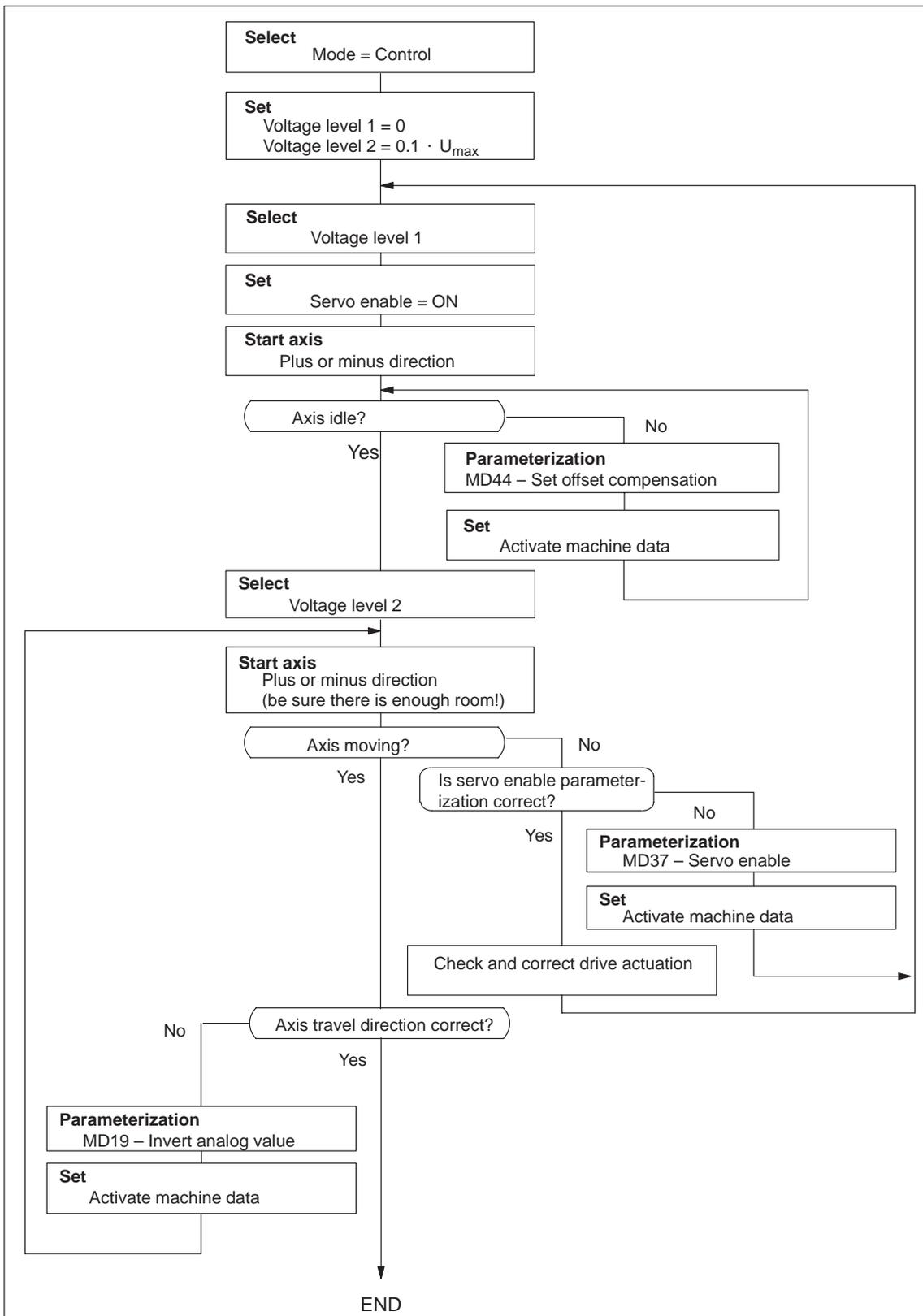
Fig. 7-5 Drive actuation
