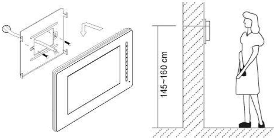
Befestigen Sie den Monitor in einer Höhe von ca. 160 cm um eine optimale Sicht auf den Monitor zu gewährleisten.Befestigen Sie die mitgelieferte Halteplatte mit den Schrauben an der Wand und hängen Sie den Monitor ein.
