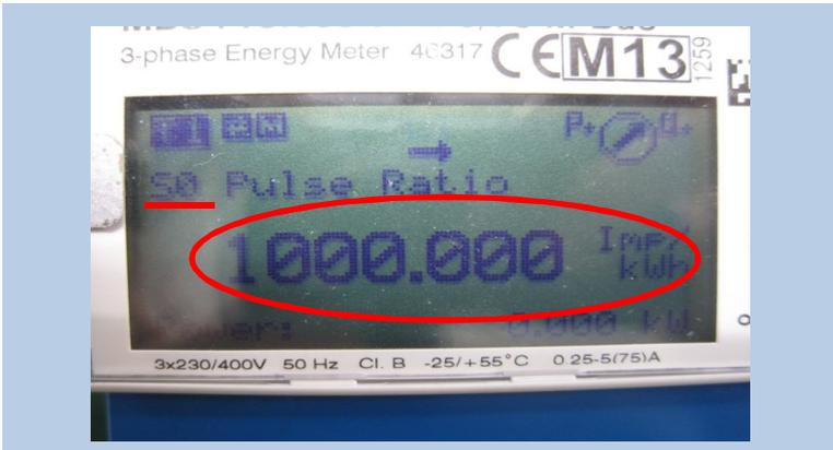
1. S0 Pulse Ratio: 1000.000 Impulse/kWh
