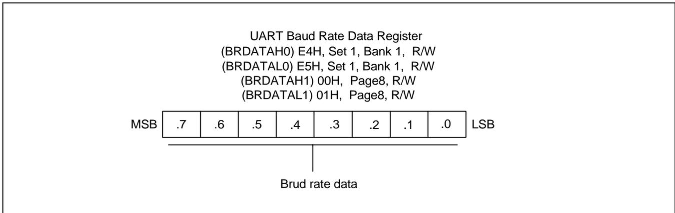
Figure 14-4. UART Baud Rate Data Register (BRDATAH0, BRDATAL0, BRDATAH1, BRDATAL1)
