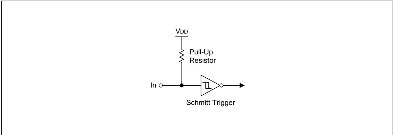
Figure 1-4. Pin Circuit Type B (nRESET)
