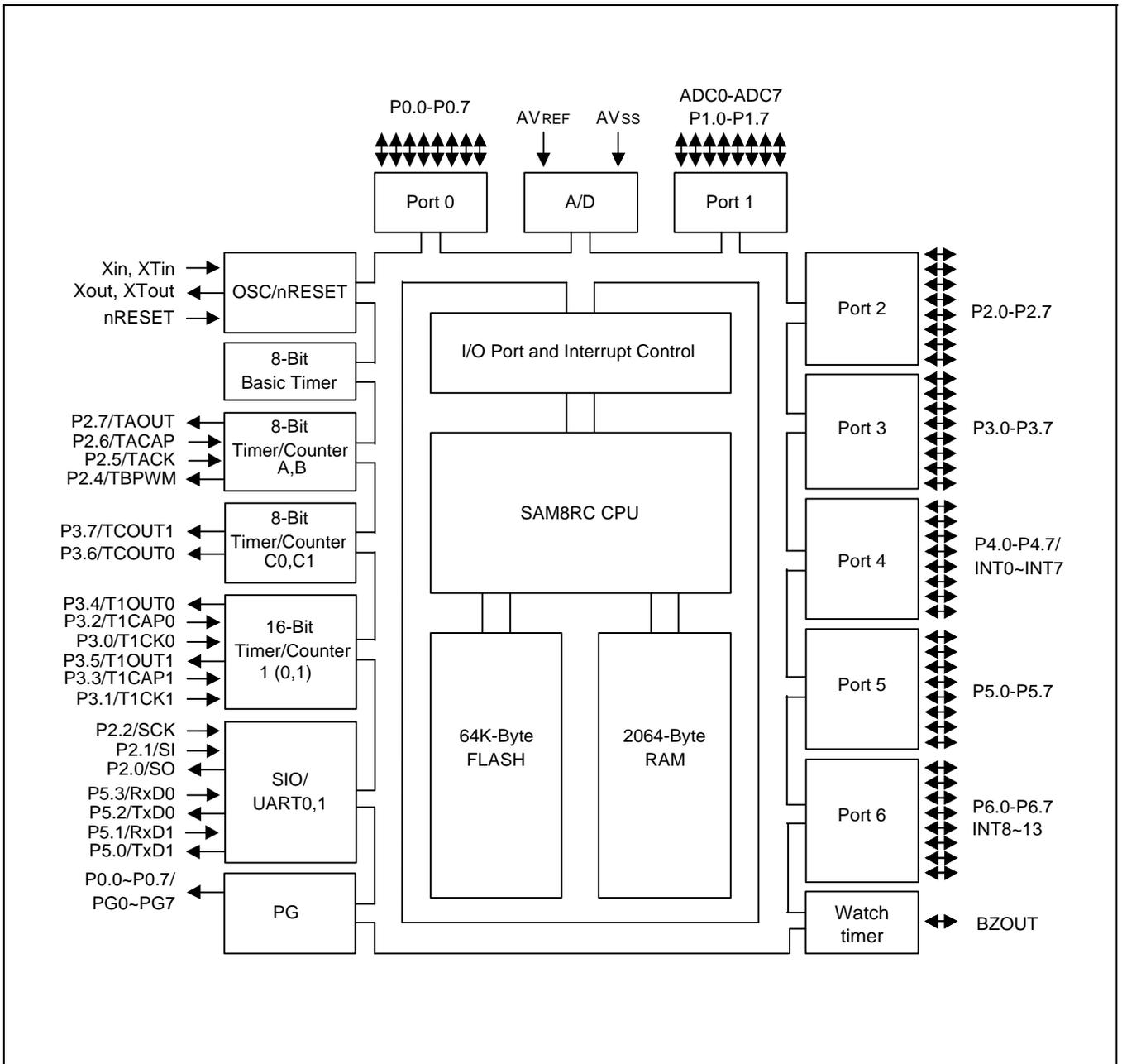
**Figure 1-1. S3F84NB Block Diagram**
