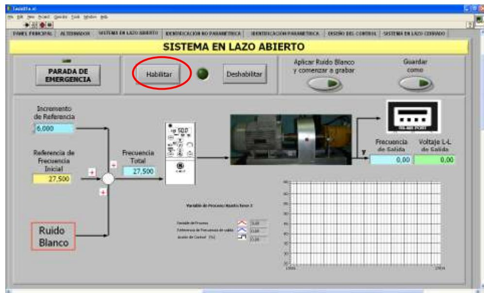
8. Incrementar la referencia hasta obtener la frecuencia de salida deseada de la Planta.
