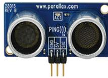
**Figure 1.5 Parallax PING))) Ultrasonic Motion Sensor.**
