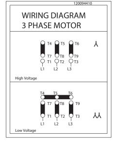
460 / 800V, 60Hz, 3Ø 208 / 360V, 60Hz, 3Ø 332 / 575V, 60Hz, 3Ø
