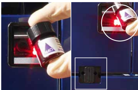
Figura 1.3: Posizione dei laser. Laser invisibili per il rilevamento dei portacampioni/portareagenti sono collocati nell'area indicata dal rettangolo. Il lettore per codice 2D (visibile) è collocato all'interno del cerchio.
