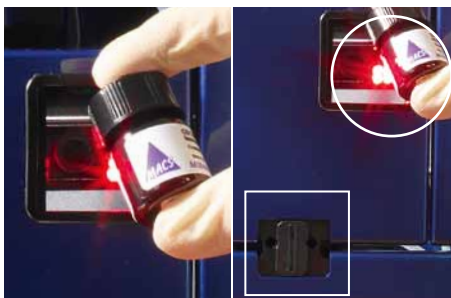
Abbildung 1.3: Position von Lasern. Im Bereich des Rechtecks befinden sich verdeckt montierte Laser zur Erkennung von Gestellen. Der (sichtbare) 2D-Barcodeleser ist hier mit einem Kreis gekennzeichnet.
