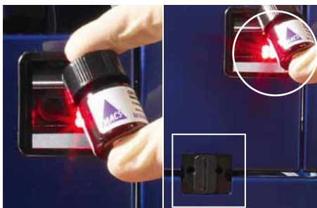
Figura 1.3: Posición de los láseres. El láser de detección del rack es invisible y se localiza dentro del área rectangular. El lector de códigos de barra (visible) está localizado dentro del círculo abierto.
