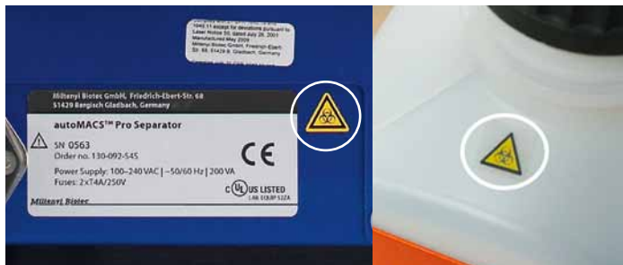
Abbildung 1.4: Warnhinweise für biologische Gefahren befinden sich rückseitig auf dem autoMACS Pro Separator (links) und oben auf dem autoMACS Pro Separator Flüssigkeitsbehälter (rechts).
