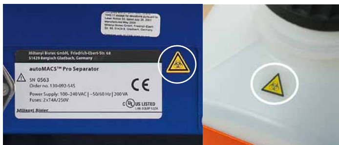
Figura 1.4: Señal de cuidado de riesgo biológico localizada en la parte inferior del panel delantero del separador autoMACS Pro (izquierda) y en la parte superior de la botella de Fluido del separador autoMACS Pro (derecha).
