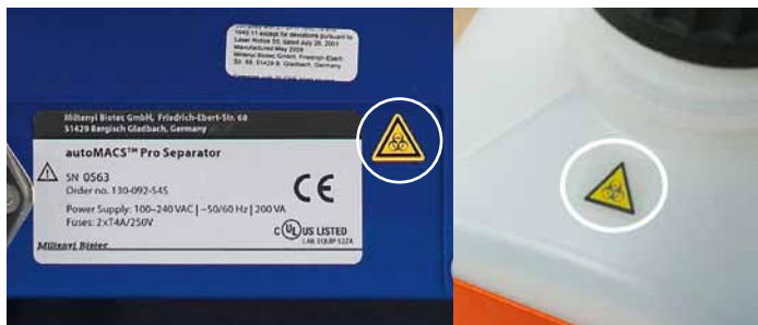
Figura 1.4: I simboli di pericolo biologico sono localizzati sulla superficie posteriore dello strumento (sinistra) e sulla parte superiore della bottiglia del fluido di scarto (destra).
