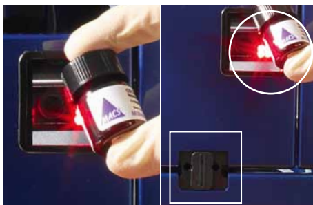
Figure 1.3: Position des lasers. Les lasers invisibles de détection de râteliers sont situés dans la zone rectangulaire. Le lecteur de code 2D (visible) est entouré d'un cercle blanc.
