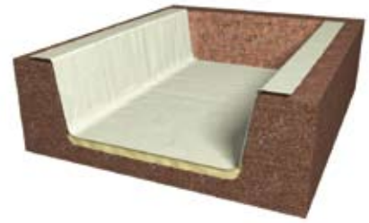
Step 3 - Lay geotextile / membrane.
