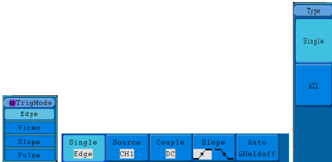
Fig. 5-17 Edge trigger menu
