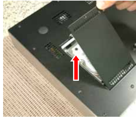
b. Remove the HDD Door
