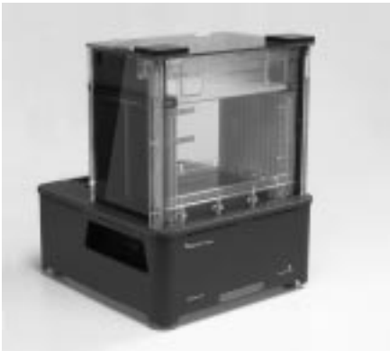
Fig 1. Ettan Dalt II Separation Unit.
