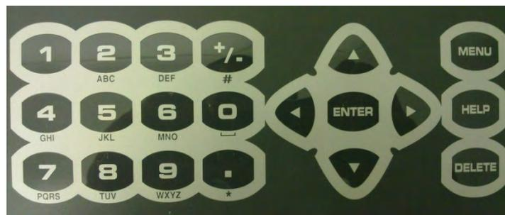
FIGURE 3: KEYPAD - ALPHANUMERIC
