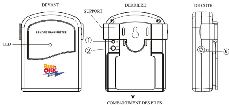
SUPPORT – Se déplie et permet de mettre le transmetteur droit sur la table.
