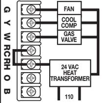
**TYPICAL COOLING AND HEATING SYSTEM (5-WIRE)**
