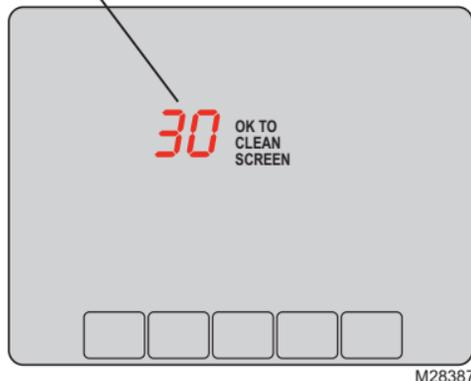
Appuyez sur **SCREEN** pour verrouiller l'écran afin de le nettoyer. L'écran restera verrouillé pendant 30 secondes pour permettre de le nettoyer sans modifier les réglages.
