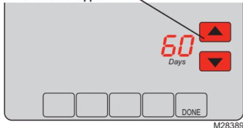
Lorsque le rappel **CHANGE FILTER** s'allume, il est temps de remplacer le filtre de l'appareil de chauffage.
