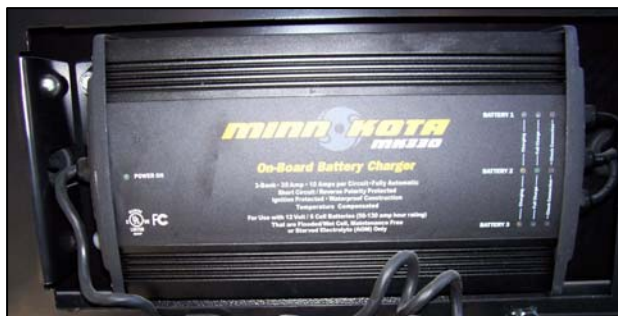
110 volt battery charger
