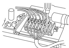
**F** Préparer les câbles électriques pour le branchement dans la boîte à bornes et les connecteur. (Voir schéma pour le branchement). Serrer les câbles d'alimentation à la bague de serrage.
