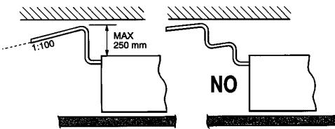
**P** A unidade possui um tubo de PVC da bomba de descarga de condensação. A bomba tem uma prevalência de 250 mm além da unidade. Descarregar a condensação por queda com uma pendência mínima de 1:100. A altura máxima necessária no tubo de descarga de condensação deve ser atingida no primeiro trecho próximo à unidade para evitar grandes refluxos de água ao ser desligado o sistema.
