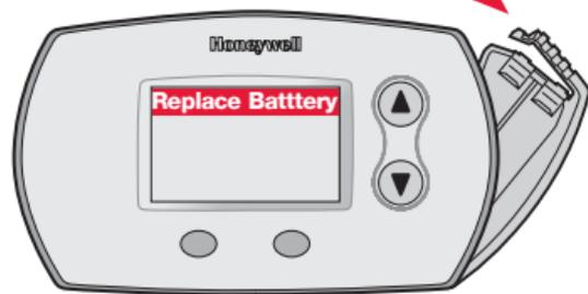
Installez des piles alcalines neuves et réinstallez le porte-piles.
