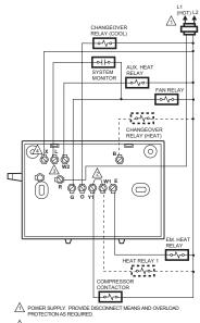
REMOVE W1-Y1 JUMPER WHEN HEAT RELAY 1 IS USED.
