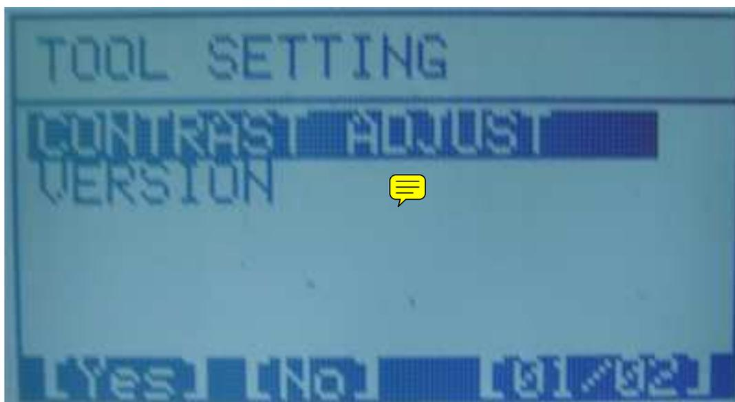
**CONTRAST ADJUST :** ADJUST THE LCD CONTRAST;
