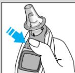
Le thermomètre ThermoScan Braun s'éteint automatiquement au bout de 60 secondes s'il n'est pas utilisé. On peut également l'éteindre directement en appuyant sur la touche « I/O » pendant au moins 3 secondes. A l'écran, le mot « OFF » clignote rapidement puis reste affiché en continu une fois la touche relâchée.
