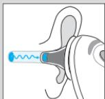
Le thermomètre ThermoScan de Braun mesure la chaleur infrarouge émise par le tympan et le tissu environnant. Pour éviter des écarts de température trop importants, la sonde de mesure de l'appareil est chauffée à une température proche de celle du corps humain. Dès que l'on place le ThermoScan Braun dans le conduit auditif, celui-ci surveille en continu le rayonnement infrarouge jusqu'à ce qu'il détecte une correspondance entre les températures et qu'une mesure exacte devienne possible.
