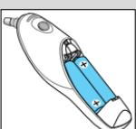
Ouvrez le compartiment des piles. Enlevez les piles usagées et remplacez-les par des piles neuves. Respectez la polarité des piles. Faites coulisser le couvercle sur le compartiment des piles jusqu'à sa bonne mise en place.
