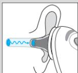
Braun ThermoScan mide el calor infrarrojo desprendido por el timpano y los tejidos adyacentes. Para evitar diferencias considerables de temperatura, la sonda se ha calentado a una temperatura muy similar a la del cuerpo humano. Una vez que se ha colocado Braun ThermoScan en el canal auditivo, éste controla de forma continuada la radiación infrarroja hasta lograr un equilibrio de temperatura y hasta que se pueda realizar una medición precisa.
