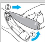
Le thermomètre est équipé de deux piles de type AA (LR 6) de 1,5 volt. Pour obtenir un fonctionnement optimal, nous préconisons d'utiliser des piles Duracell® alcalines. Remplacez les piles lorsque le symbole correspondant apparaît à l'écran.
