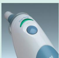
Si la medición se realiza en otra persona, se puede utilizar la luz «ExacTemp». La luz parpadea si la sonda se ha introducido de forma adecuada durante el proceso de medición y permanece encendida si se ha realizado la medición correctamente.
