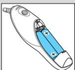
Abra el compartimento de las pilas. Retire las pilas y sustitúyalas por pilas nuevas asegurándose de que los polos están en la posición correcta. Deslice la tapa del compartimento de las pilas hasta que encaje en un sitio.
