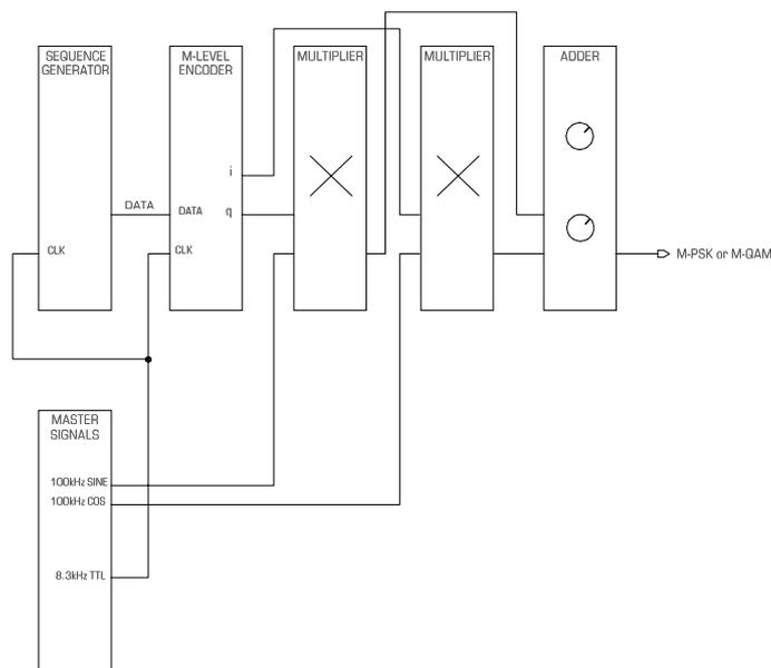
m-QAM & m-PSK Generator Block Diagram
