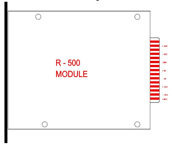
FIG. 3 500 Series module edge connector
