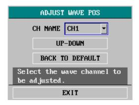
Figure 12-8 ADJUST WAVE POS menu
