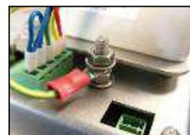
11) Connect MEC sensor earth to earth stud
