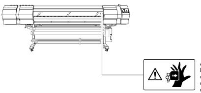
Attention : Têtes d'impression mobiles Les têtes d'impression sous le couvercle se déplacent à haute vitesse et représentent un danger. Ne jamais insérer la main ou les doigts dans l'ouverture. This machine is a precision device. To ensure the full performance of this machine, be sure to observe the following important points. Failure to observe these may not only result in loss of performance, but may also cause malfunction or breakdown.
