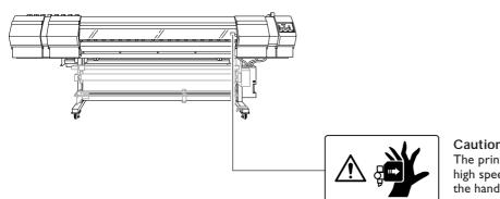
Caution: Moving Print Heads The print heads inside the cover move at high speed and pose a hazard. Never insert the hand or fingers into the gap. La manipulation ou l'utilisation inadéquates de cet appareil peuvent causer des blessures ou des dommages matériels. Les précautions à prendre pour prévenir les blessures ou les dommages sont décrites ci-dessous.
