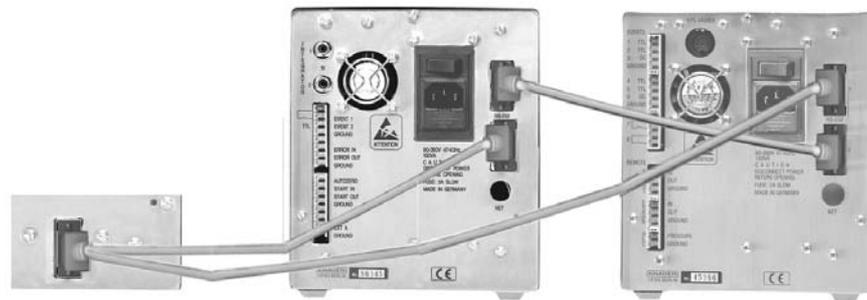
Abb. 25 Vernetzung der HPLC-Pumpe K-1001 mit einem PC und weiteren Geräten
