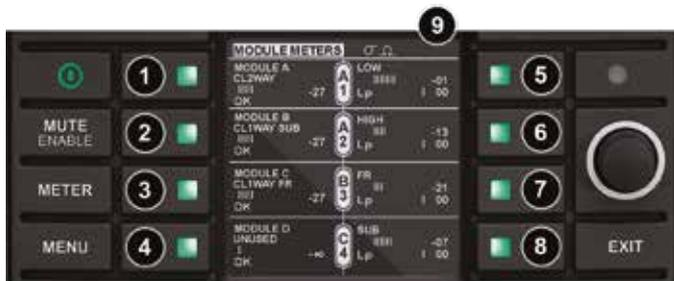
**Figure 7.12: Meter Mode > Module Meters View**
