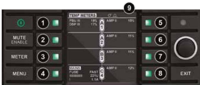
**Figure 7.10: Meter Mode > Temperature View**
