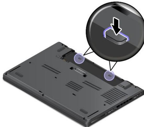
8. Drehen Sie den Computer wieder um und setzen Sie den externen Akku wieder ein. Schließen Sie das Netzteil und alle Kabel an.
