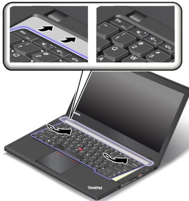
3. Stellen Sie sicher, dass die Schraubenköpfe vollständig freigelegt sind. Legen Sie die Schraubenköpfe anderenfalls frei, indem Sie den Tastaturrahmen mit dem flachen Ende des Tastatur-Multifunktionswerkzeugs nach vorne schieben.
