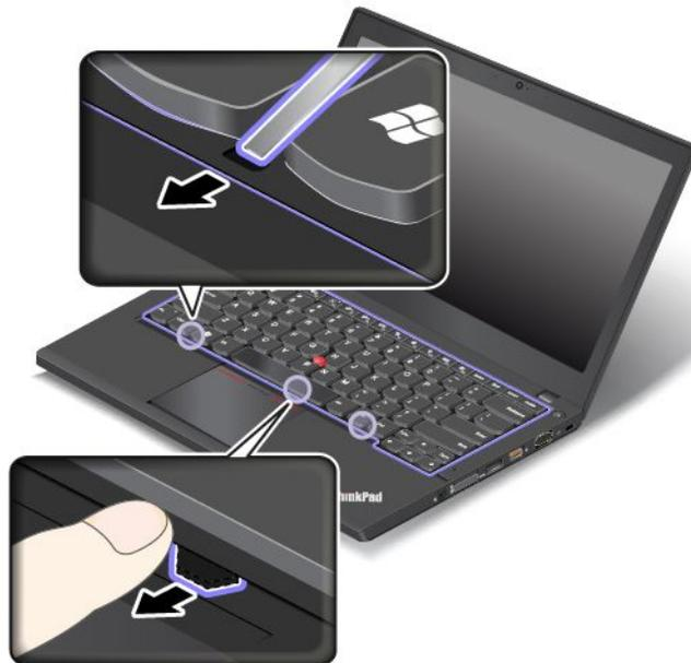
6. Führen Sie das flache Ende des Tastatur-Multifunktionswerkzeuges wie in der Abbildung gezeigt an den Seiten der Tastatur ein und schieben Sie den Tastaturrahmen nach hinten. Stellen Sie sicher, dass zwischen dem Tastaturrahmen und der Tastaturblende kein Spalt ist.
