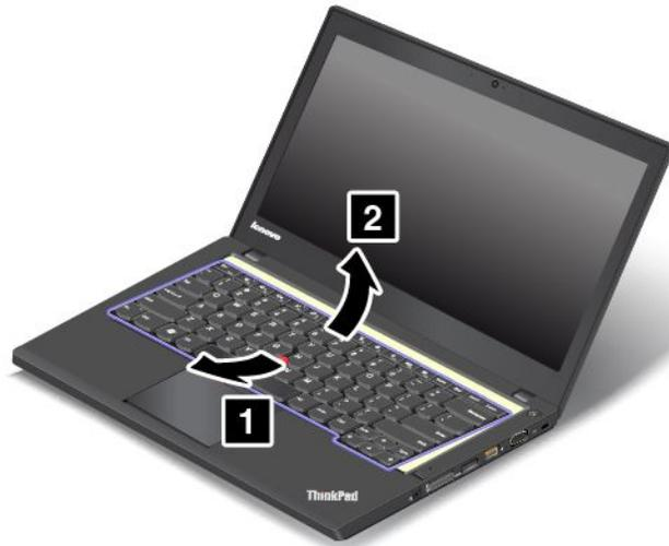
9. Legen Sie die Tastatur auf die Handablage und ziehen Sie die Stecker ab. Anschließend entfernen Sie die Tastatur.
