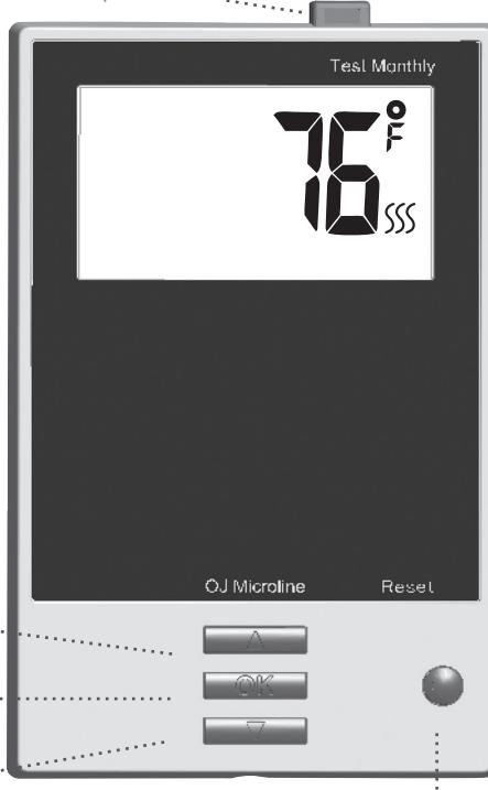
nuevo punto de ajuste. Después pulse el botón **TEST** (Prueba) en la parte superior del termostato. La prueba tiene éxito si se ilumina la luz roja en el botón **TEST** y en la pantalla aparece **GROUND FAULT** (Fallo a tierra). Si esto no ocurre, verifique la instalación o comuníquese con un electricista. Pulse el botón **Standby/Reset** (En espera/reajuste) para reajustar el GFCI.
