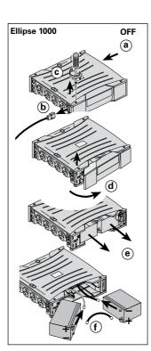
Attention : lors du raccordement des batteries, une inversion des polarités + (rouge) et - (noir) provoque la destruction de l'appareil.
