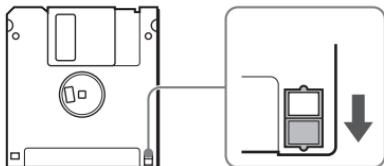
Zum Aufheben des Schreibschutzes einer Diskette, schieben Sie den Schreibschutzschalter in die nachstehend abgebildete Richtung.
