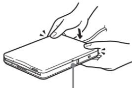
Richten Sie die Kerben in der Mitte der Seitenkante der Platte an den Haken am Laufwerk aus.
