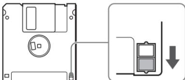
Per rimuovere la protezione dalla scrittura di un disco è sufficiente spingere la linguetta di protezione dalla scrittura nel modo visto in figura.
