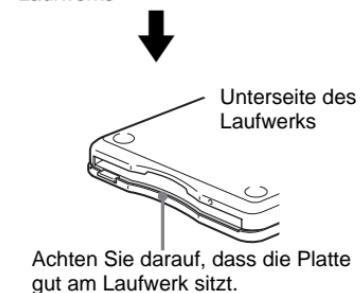
Achten Sie darauf, dass die Platte gut am Laufwerk sitzt.
