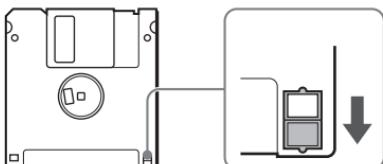
Чтобы снять защиту дискеты от записи, передвиньте язычок защиты от записи, как показано на рисунке.
