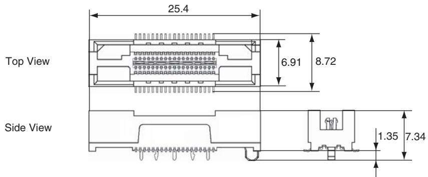
**Figure B-6. SICA Connector (SICA2P20S)**
