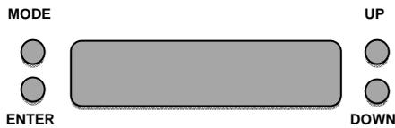
Durch Drücken der Mode-Taste können Sie sich im Hauptmenü bewegen. Zur Auswahl des gewünschten Menüpunktes drücken Sie die Enter-Taste. Durch Drücken der Up/Down-Taste können Sie die Auswahl verändern. Bestätigen Sie jede Änderung durch Drücken der Enter-Taste. Der jeweilige Modus kann durch die Mode-Taste verlassen werden. Die jeweiligen Funktionen werden im Folgenden aufgeführt.
