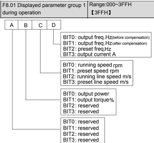
**Fig. 5-46 LED displayed parameter group 1 in operation**
