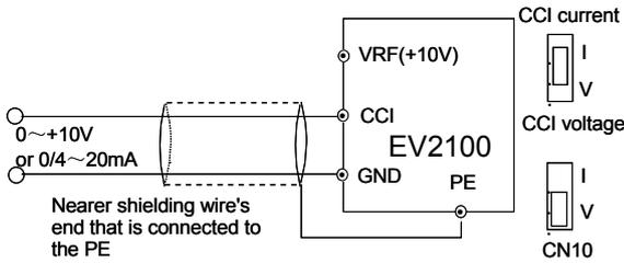
**Fig. 3-15 Wiring CCI**
