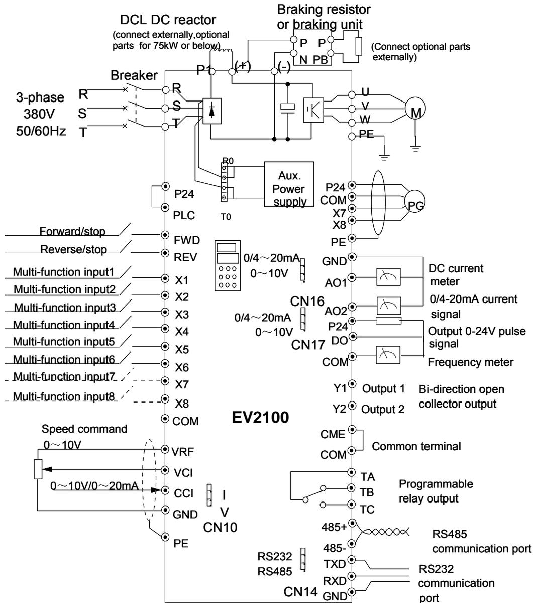
Fig. 3-10 Basic wiring 2
