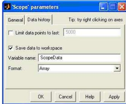
**Fig. 8.13** Scope block parameter settings
