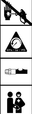
**Perigo de injeção de líquidos à alta pressão:** a pulverização ou vazamentos à alta pressão podem injetar líquido no corpo.
