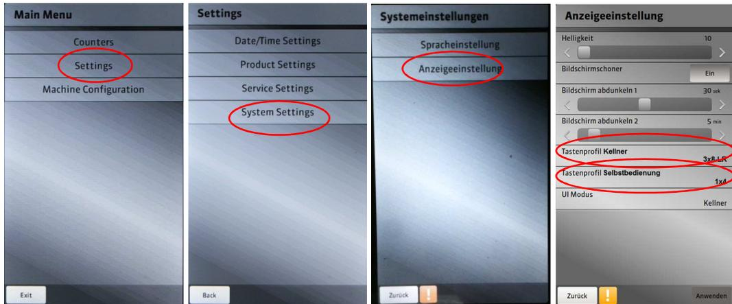
Sie haben die Möglichkeit das Tastenprofil der Produkttasten für den Kellner- bzw. den Selbstbedienungs-Modus zu ändern.
