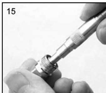
15. Coloque la junta en el alojamiento (10).
