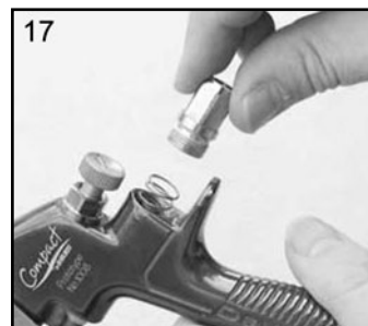
17. Vuelva a colocar el muelle de la válvula y el tornillo en el alojamiento (10).
