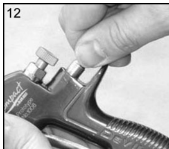
12. Coloque el asiento de válvula en el cuerpo de la pistola.
