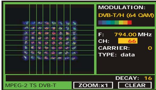
Figure 40.- Constellation Diagram. DVB-T/H (QAM 64) signal.
