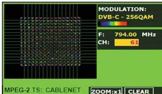
Figure 42.- Constellation diagram. DVB-C (QAM 256) signal.
