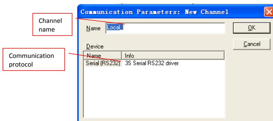
**Figure 8-3-5 New Channel**
