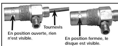
8. Nettoyez ou remplacez le clapet. Un solvant, comme du diluant à peinture ou du décapant pour vernis, peut être utilisé pour nettoyer le clapet.
