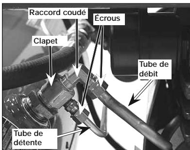
6. Dévissez le raccord coudé de la soupape de retenue (en tournant dans le sens contraire des aiguilles d'une montre) à l'aide d'une clé réglable. Notez l'orientation du raccord coudé pour faciliter la pose plus tard.
