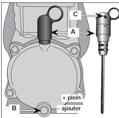
**REMARQUE :** Utilisez une huile conçue spécifiquement pour les compresseurs d'air, telle que l'huile pour compresseurs d'air PAS1 de Porter-Cable. L'huile peut être acheté au magasin où vous avez acheté le compresseur d'air.
