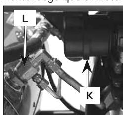
**Válvula reguladora (L):** Cuando el compresor de aire se encuentra funcionando, la válvula reguladora esta "abierta", permitiendo la entrada del aire comprimido al tanque de aire. Cuando el nivel de presión del tanque alcanza el punto de "corte", la válvula reguladora "se cierra", reteniendo la presión del aire dentro del tanque.
