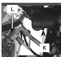
**Soupape de retenue (L) :** Lorsque le compresseur fonctionne, la soupape de retenue est « ouverte », permettant à l'air comprimé d'entrer dans le réservoir d'air. Quand le compresseur d'air atteint la « pression de rupture », la soupape de retenue « se ferme », permettant à l'air pressurisé de demeurer à l'intérieur du réservoir d'air.
