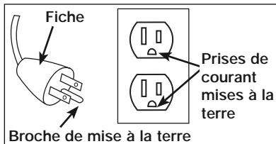
**⚠ AVERTISSEMENT** **UNE MISE À LA TERRE INAPPROPRIÉE PEUT ENTRAÎNER DES CHOCS ÉLECTRIQUES.**
