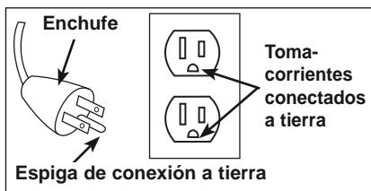
2. Asegúrese de que el tomacorriente que será utilizado tenga la misma configuración que el enchufe de conexión a tierra. **NO UTILICE UN ADAPTADOR.** Ver figura.
