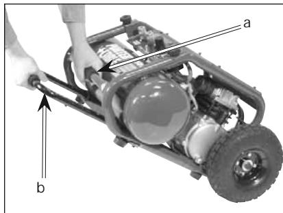
2. Glissez la poignée (b) vers l'extérieur jusqu'à ce qu'il se verrouille en place.
