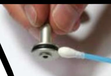
**NOTE: THE ADJUSTER PISTON (COLOURED CAP THAT THE FRONT SPRING RESTS IN) DOES NOT NEED TO BE REMOVED FROM THE LPR CAP FOR REGULAR MAINTENANCE.**
