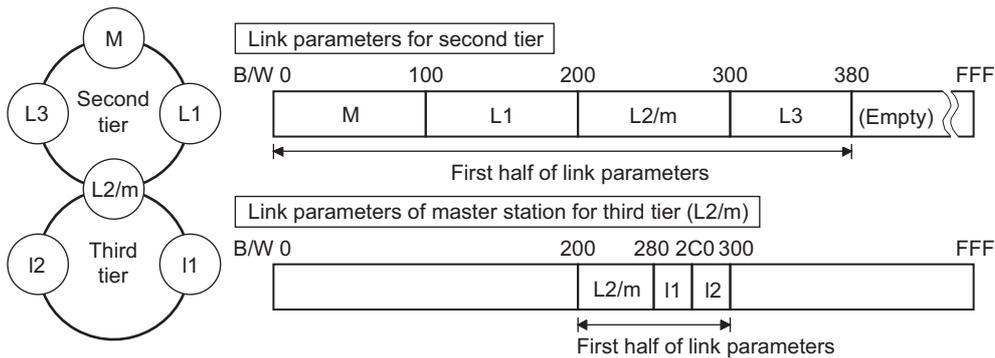
**Figure 4.2 Link parameter setting example**
